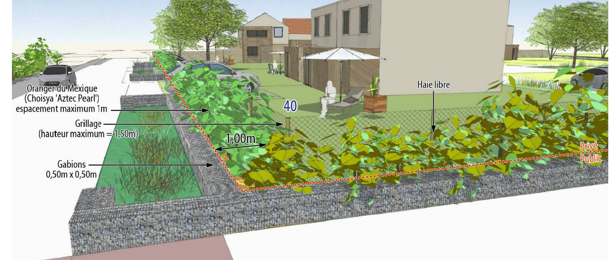
Traitement de la limite de lot le long de la rue des Tisserands
